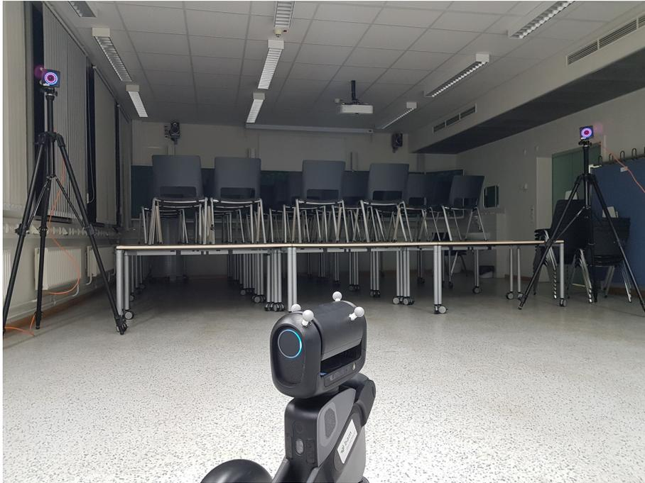
Abbildung 3.1: Dieses Bild zeigt den Segwayroboter mit am Roboterkopf befestigten Sensoren und zwei Kameras des Trackingsystems im Hintergrund
