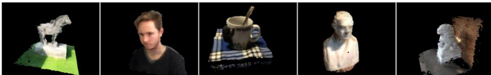
Abbildung 1.5: Ergebnis einer 3D-Rekonstruktion aus einer Videoaufnahme mit einer Länge von 20 Sekunden durch MobileFusion. Zu finden in der Publikation: [38].
