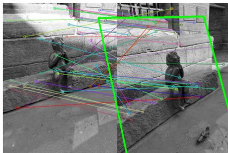
Abbildung 2.4: Ergebnis vom RANSAC-Algorithmus zum Entfernen von Ausreißern und die daraus abgeleitete Transformationsmatrix.
