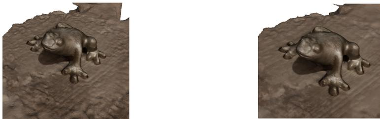
Abbildung 5.1: Links: Unverarbeitetes 3D-Modell nach der durch Meshroom ausgeführten 3D-Rekonstruktion. Rechts: 3D Modell nach der Bearbeitung durch die Anwendung MeshLab.
